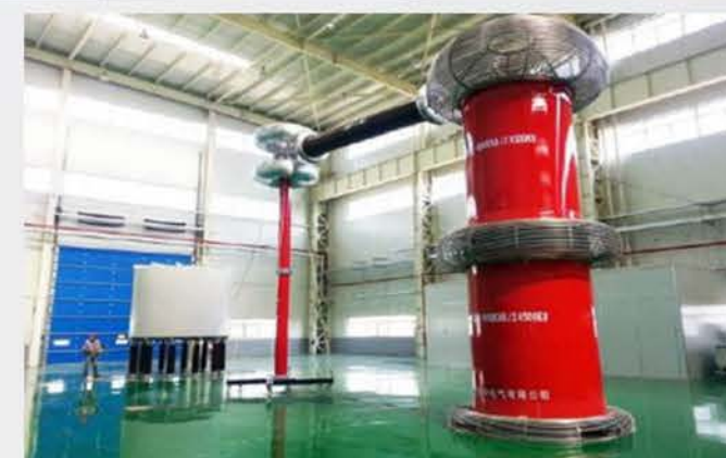
1000kV Hi-Pot Transformer
